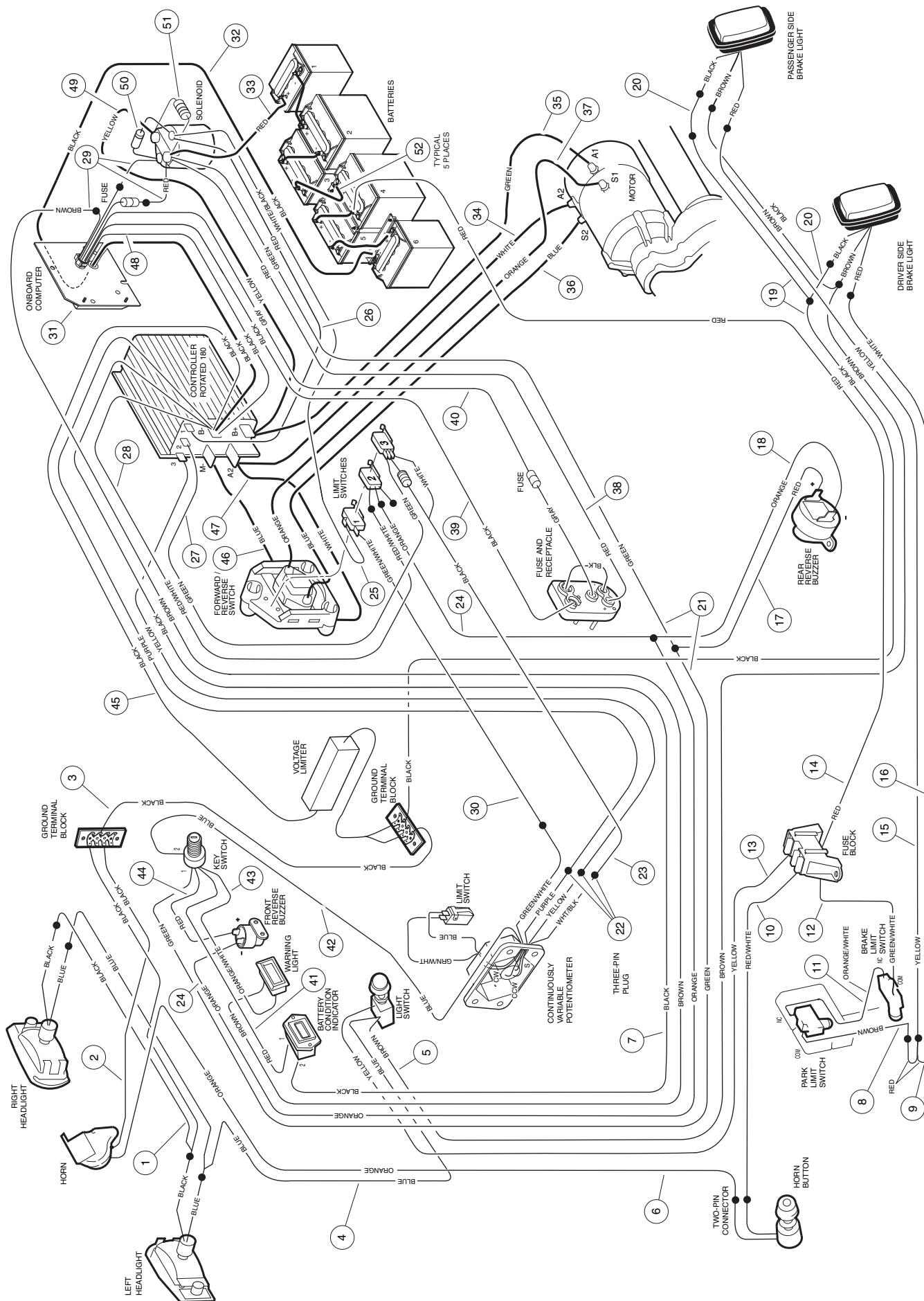
**WIRING—****RESORT VILLAGER POWERDRIVE ELECTRIC VEHICLE****12****E**
