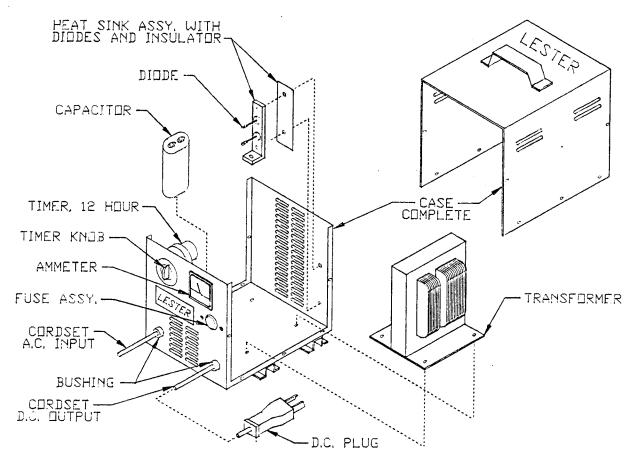
PORTABLE LESTER CHARGER (TYPICAL) FOR COMPONENT IDENTIFICATION SEE PARTS LIST FOR PORTABLE CHARGERS
