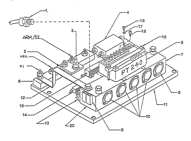
62-Ø24-ØØ PWR-TRON 24Ø SPEED CONTROLLER AND PARTS LIST
